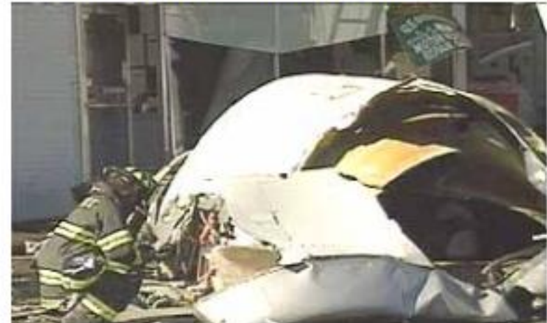
Triebwerk des Airbus, der am 12.11.2001 in New York nach dem Start Seitenruder und Triebwerke verlor und abstürzte.
